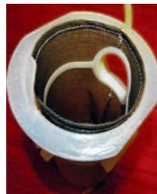
La poche souple s'insère à l'intérieur du panier et est maintenue par un collier semi-rigide.
